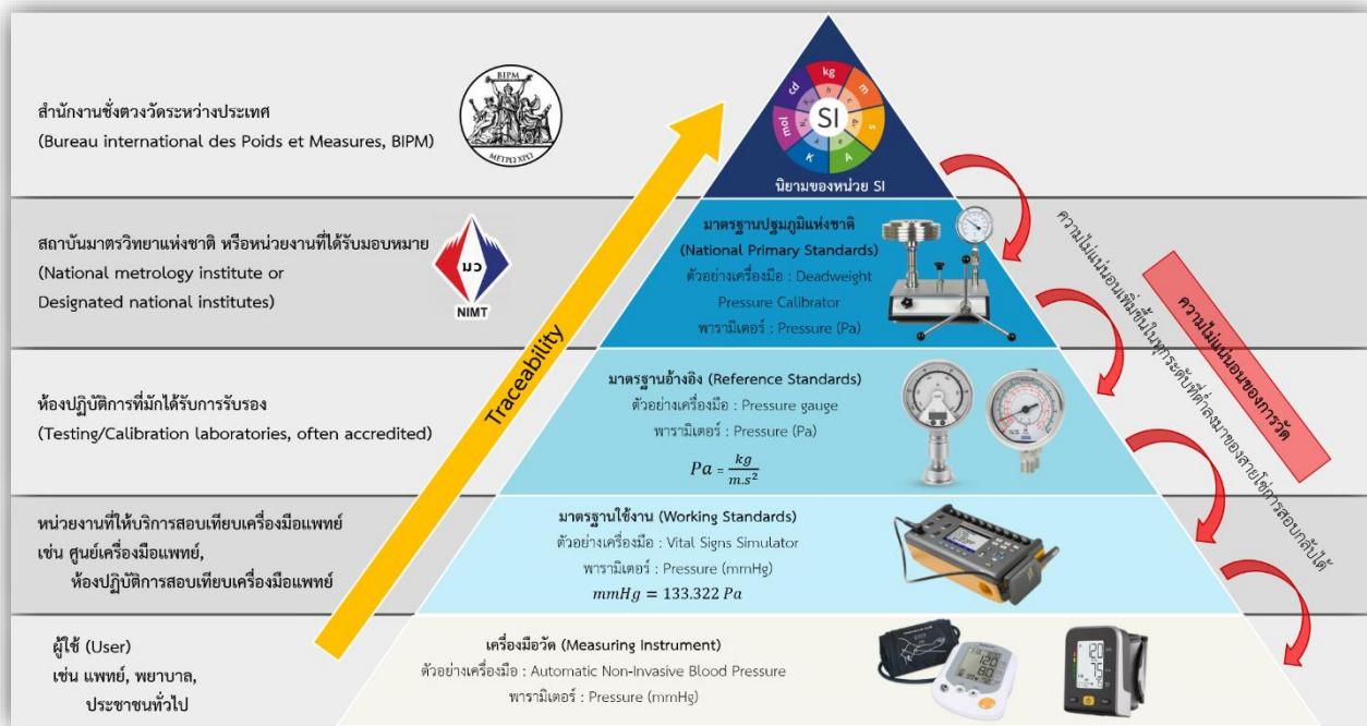
ภาพที่ 2 ตัวอย่างสายโซ่การสอบกลับได้ทางการวัดของเครื่องวัดความดันโลหิตอัตโนมัติแบบไม่รุกราน
