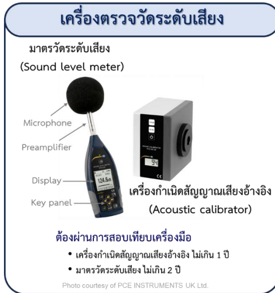
ภาพที่ 2 เครื่องมือที่ใช้ในการตรวจวัดเสียง: มาตรวัดระดับเสียงและเครื่องกำเนิดสัญญาณเสียงอ้างอิงตามมาตรฐาน IEC 60942 Class 1
